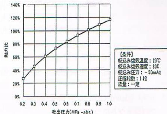
図4 コンプレッサの吐出圧力と消費電力<sup>3)</sup>
